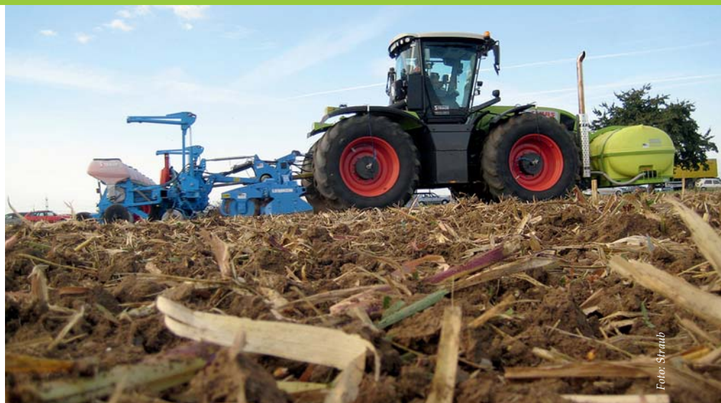
Bestellung von Mais mit Lemken Kreislegge und Monosem Einzelkornsämaschine; der flüssige Unterfußdünger befindet sich im Fronttank.
